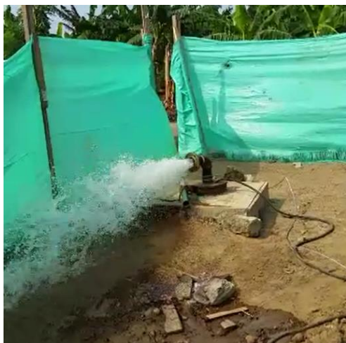
Ilustración 3.22 Instalaciones de bombeo pozo Maná, pruebas de bombeo, cercamiento de la instalación. (fotos de 28 de Abril y 29 de Julio de 2016 respectivamente)
