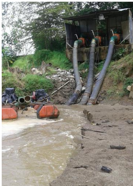
Ilustración 3.6 Dragas para remoción de arenas en las válvulas de pie para la succión de los equipos de bombeo.
