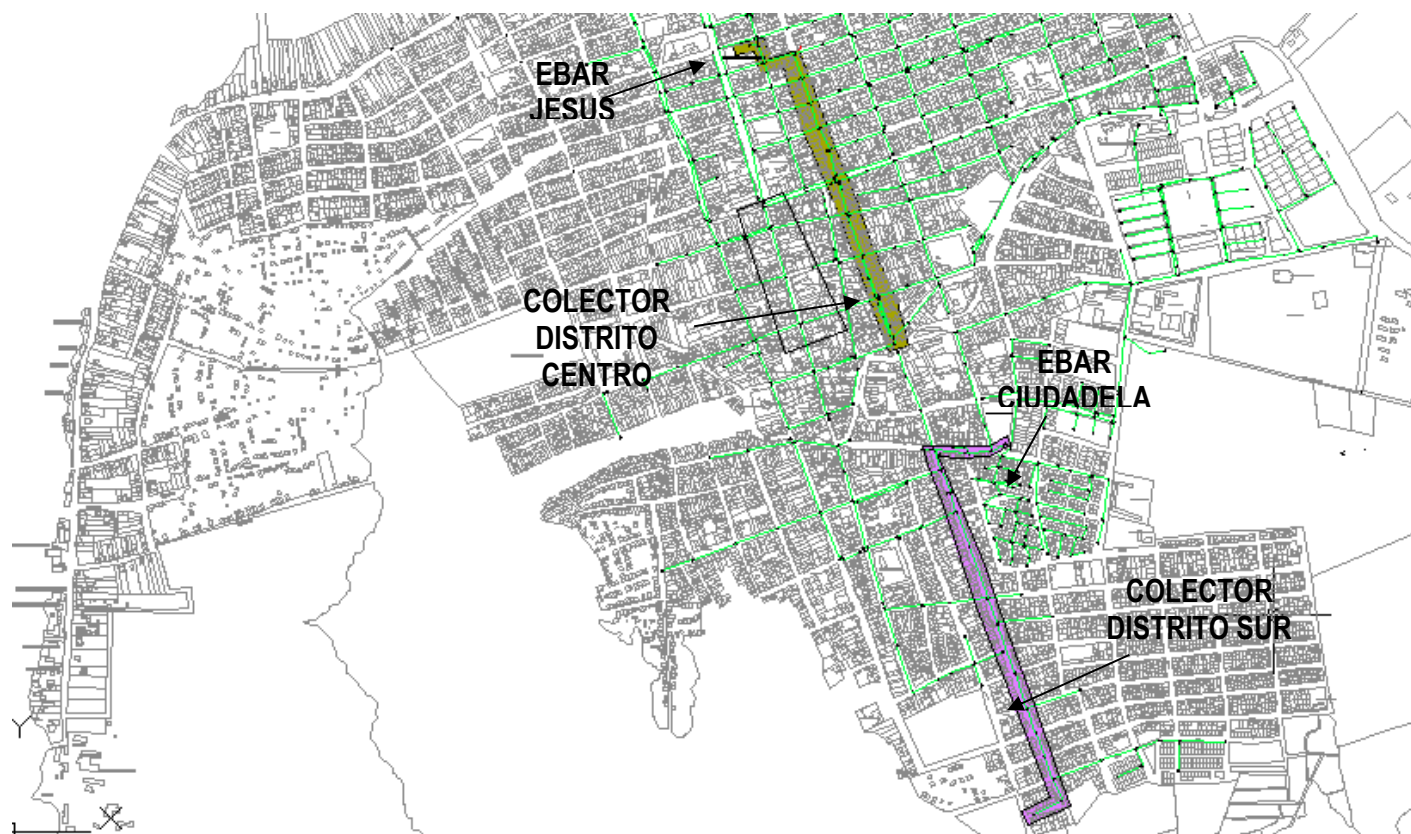
Ilustración 13 Colectores existentes de los distritos en estudio del alcantarillado de Turbo
