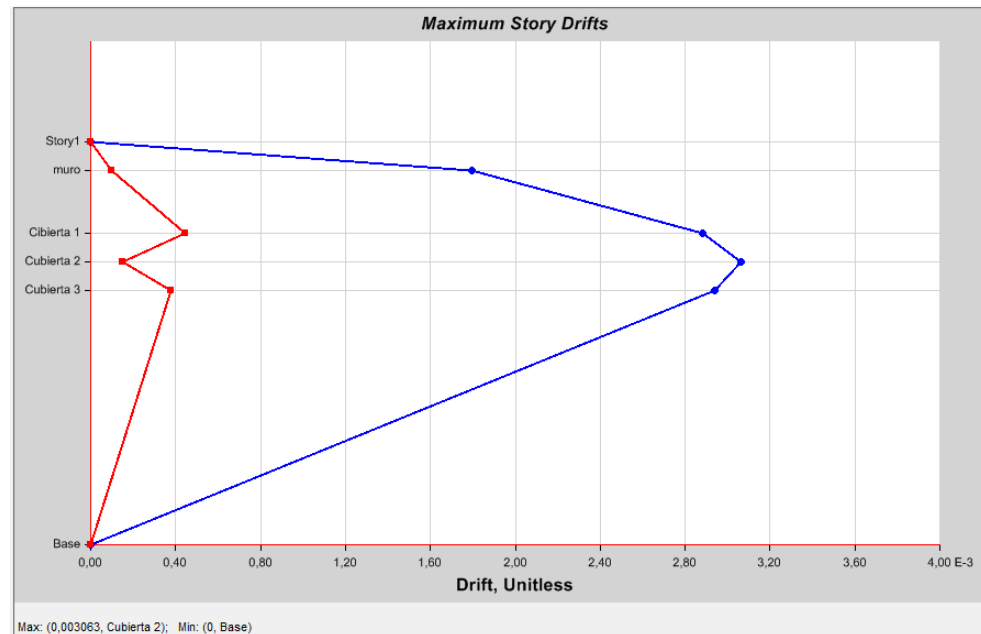
Figura No 3-7 Chequeo derivas X, aulas polivalentes.
