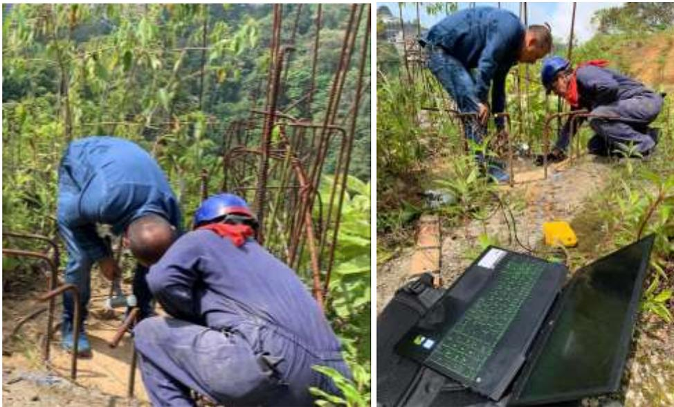
**Figura 43. PIT en los Caissons del nivel -5.00 m**
