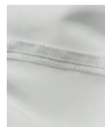
Costuras y cierres de la prenda Cierre en filete puntada de seguridad (overlock 800)
